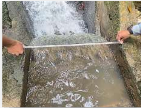
Figura 1. Medición Caudal método vertedero rectangular Quebrada Santana
