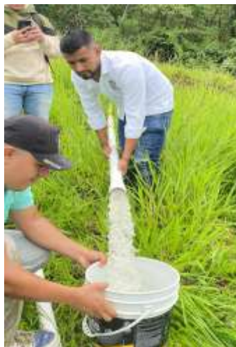
Figura 2. medición caudal método volumétrico punto antes de sistema de distribución IE Aborígenes, fuente Quebrada Santana
