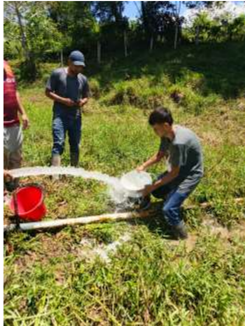
Figura 3. Medición caudal método volumétrico punto antes de sistema de distribución IE Aborígenes, fuente Quebrada Yanamuco
